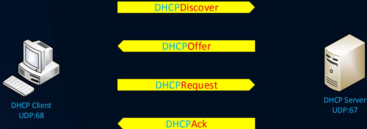
Nach Erhalt der DHCP**Ack** Meldung vervollständigt der Client seine TCP/IP Konfiguration incl. der vom Server übermittelten Optionen.
