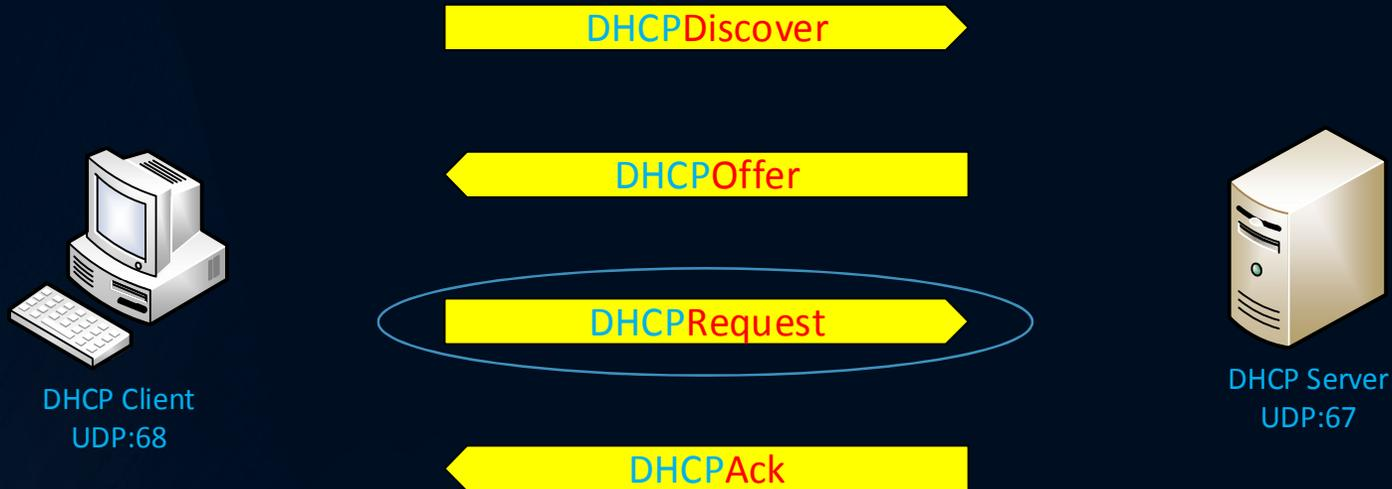
Der Client zeigt dem Server an, dass er die IP Konfiguration akzeptiert, indem er eine DHCPRequest Meldung (mit der IP Adresse) an den Server sendet.
